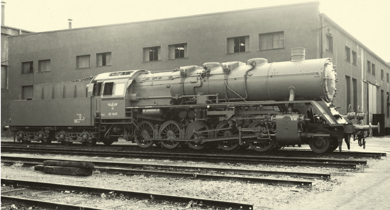
50 1669 steht nach ihrer Fertigstellung 1942 im Fabrikhof der Firma Krauss-Maffei. Wie der Buchstabe „K“ (für Kriegslok) und die Zahl auf dem Zylinderblock ausweisen, war sie die 30. entfeinerte Lokomotive der Baureihe 50 von Krauss-Maffei. | WERKFOTO KRAUSS-MAFFEI
