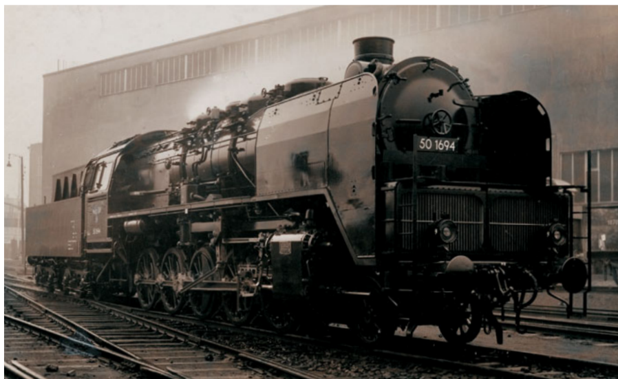
Die 50 1694 besaß ab Werk zwei Rohrkühlerelemente zur Unsichtbarmachung des Abdampfs. WERKFOTO KRUPP/SLG. ASMUS
