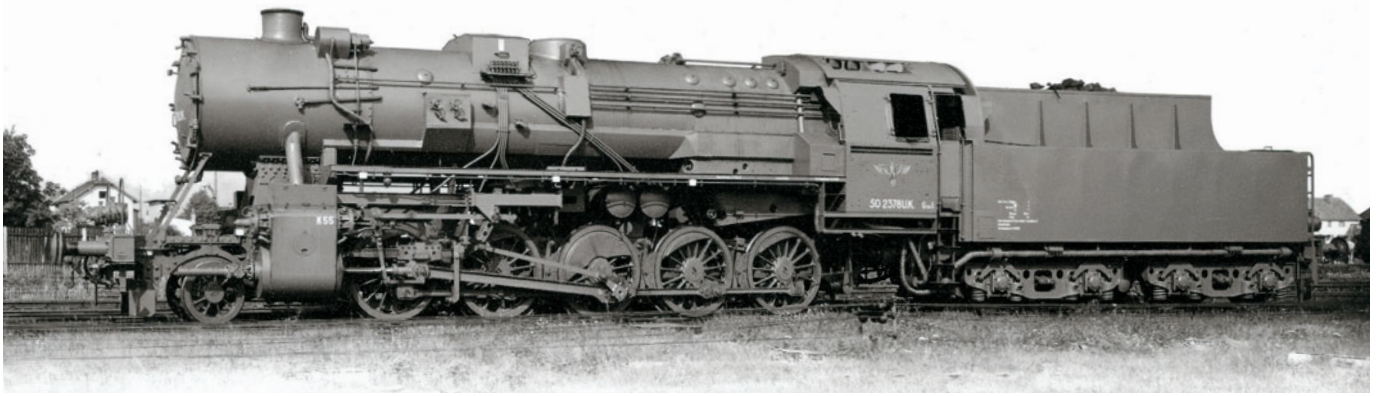
50 2378 ÜK. Die zwischen August und November 1942 bei Krauss-Maffei gebauten Lokomotiven sind weitgehend vereinfacht: vereinfachte Stangen, ÜK-Führerhaus, Kessel nur mit Dampfdom und Blechsandkasten. | WERKFOTO KRAUSS-MAFFEI
