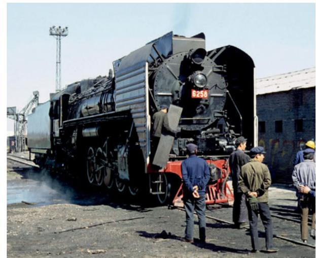
**NACH DER HAUPTAUSBESSERUNG** in Changchun wird QJ 6258 in Betrieb gesetzt und abgenommen. 21.9.1991 (BH)
