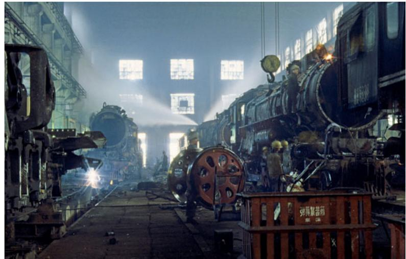
**RICHTHALLE IM AUSBESSERUNGSWERK** Changchun, wo an den revidierten Loks der Reihe QJ Kesseldruckproben vorgenommen werden. 21.9.1991 (BH)
