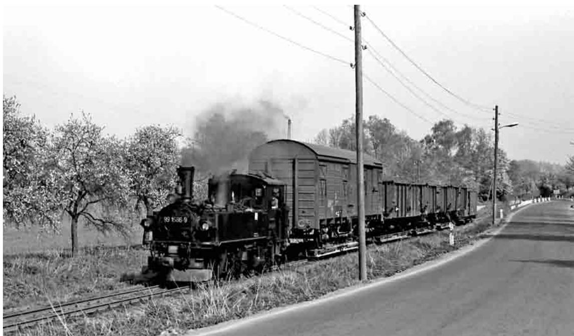
Meyerlokomotivet 99 1586-9 med godsvogne på transportører og bagest en smalsporspakvogn efter Altmügeln, indrammet af en cyklist og en gammel Wartburg 311.
