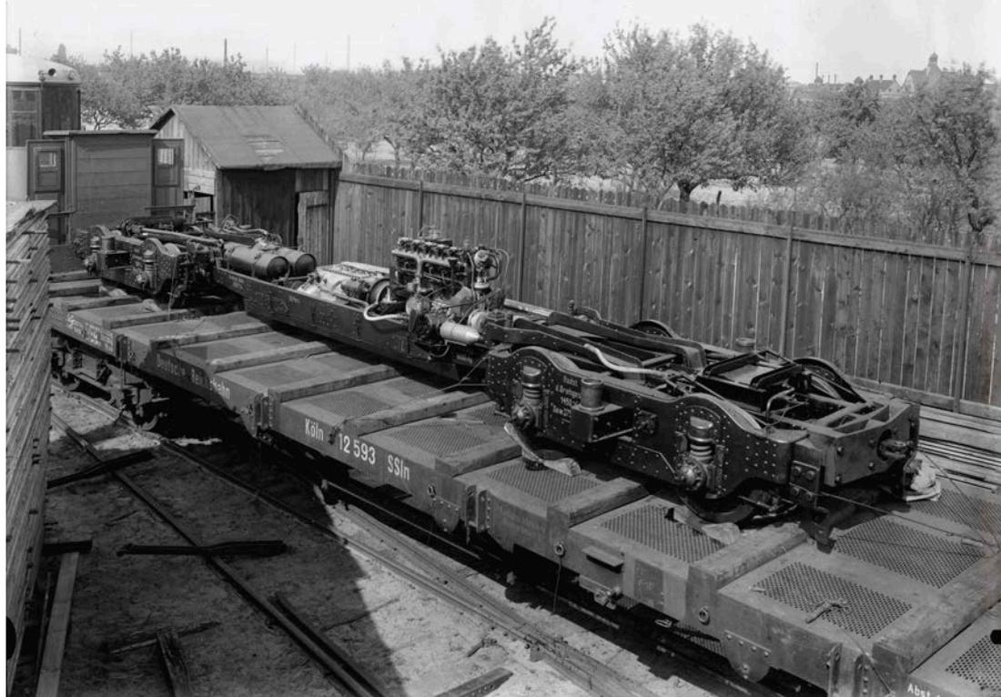
Leichtbau geht anders. Die DWK-Triebwagen der 1920er-Jahre waren – anders als die zeitgleich entstandenen Benzoltriebwagen der AEG, die viele Elemente aus dem Kraftfahrzeugbau übernommen hatten – ausgesprochene Schwergewichte. Das in weiten Teilen genietete Untergestell des Triebwagens 2 trägt auffallend viele Beschriftungen Gebr. Gastell/Slg. Dr. Löttgers
